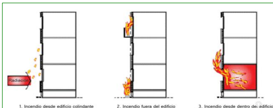
Figura 1. Mecanismo de propagación del fuego en fachadas. Fuente: Kotthoff y Riemesch.
